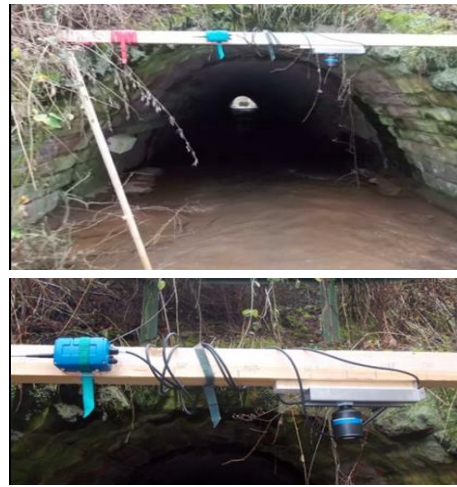
Montage der Sonde mit Unterkonstruktion
